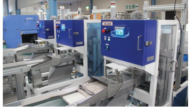
▲ブランケットフォルダーから集合コンベアで全自動包装機へ搬送して作業を効率化。包装機は SS-002
