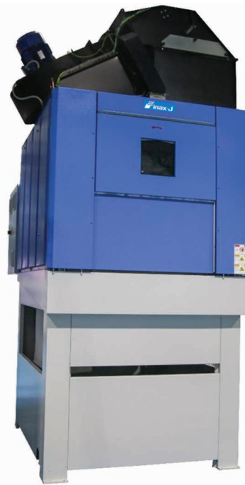
▲ガス式/蒸気式乾燥機DT。世界中で1万台超の販売実績を有する低エネルギー消費型乾燥機。「I-nax-J」の自社ブランドとして日本国内に展開していく
