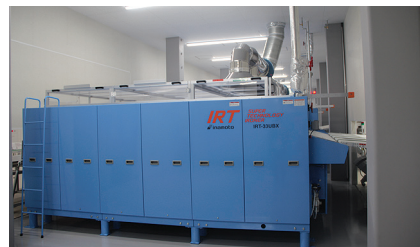
▲ロール機前後は隔壁で暑さ対策
