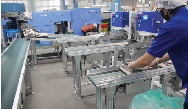
▲ブランケットフォルダーから集合コンベアで全自動包装機へ搬送して作業を効率化。包装機は SS-002
