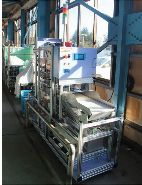
◀昨年12月に導入した三方全自動包装機「SS-015」。航空機客室用の大判ブランケットを自動で効率良く脱気包装する
