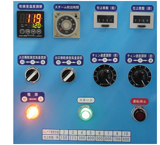
▲操作パネルのコンベア速度の目盛はいずれもMAXの10に設定。時間800点×2で1600点を仕上げる
