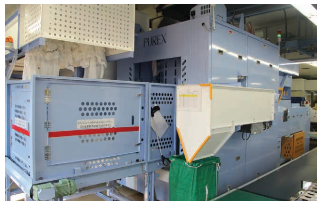
▲ATA-BFM2に搬送するタオルは上部のコンベアで待機し、2台のうち空いたほうに落とすようにセンサーで制御されている
