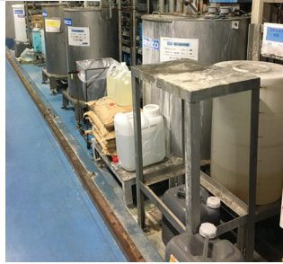
▲過酢酸のコンテナ（1トン）から連洗とバッチに直接供給する
