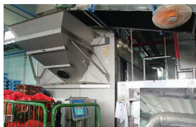
▲連洗は10槽から12槽に増やし、バッチ洗いは再洗のみにして効率化を図った。乾燥機は5台
