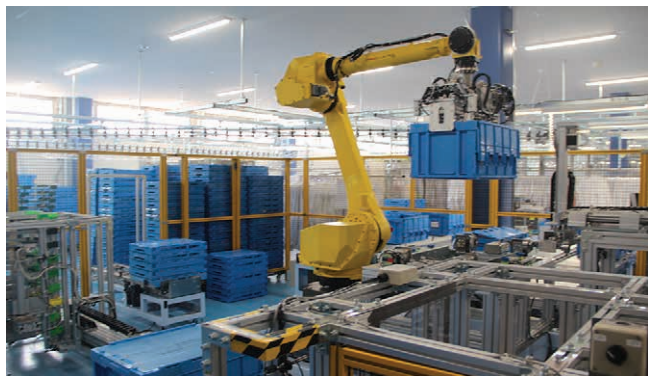
▲納品用のコンテナを組み立て、搬送するロボット
