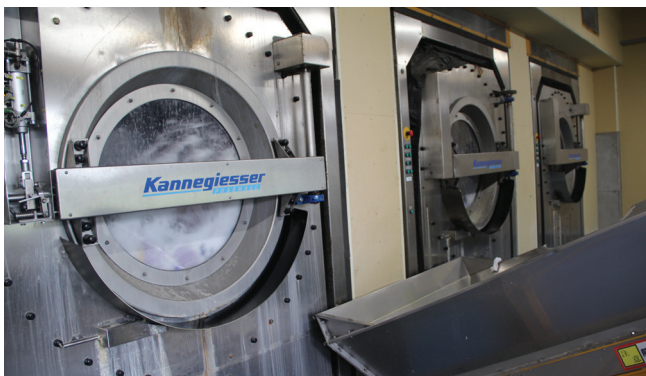
▲バリアウォール式バッチ洗濯機 140kg4台
