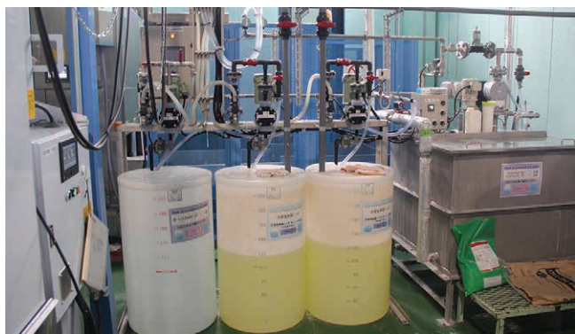
▲連洗への自動投入装置。右がおしほり専用粉末洗剤ルピカル、左が次亜塩素酸ソーダとオーリス
