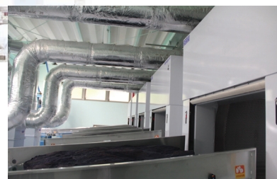
▲連洗は10槽から12槽に増やし、バッチ洗いは再洗のみにして効率化を図った。乾燥機は5台
