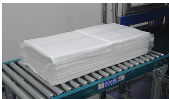
▲脱気して包装されたタオルは結束なしで積み込みできる
