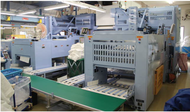
▲両面品質検査装置付タオルフォルダー「TUZ-2N」
