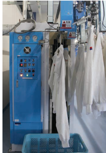
▲操作パネルのコンベア速度の目盛はいずれもMAXの10に設定。時間800点×2で1600点を仕上げる
